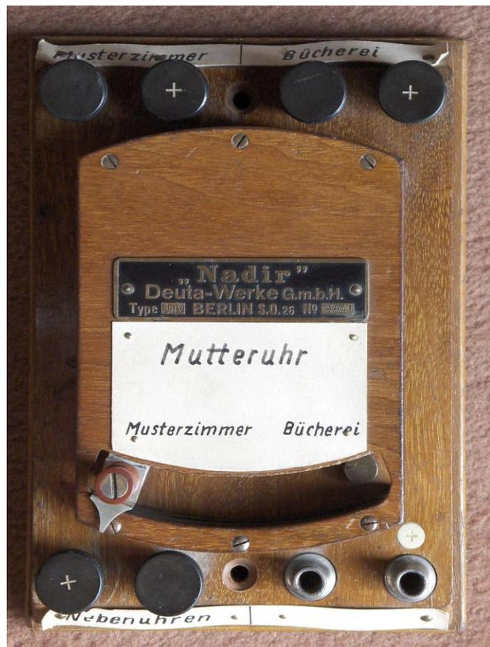
**Aktueller Schaltkasten mit dem 2007 wieder eingebauten Umschalter der Mutteruhren, dem Nebenuhrverteiler, Resten der historischen Anlage und neueren Hinzufügungen.**
