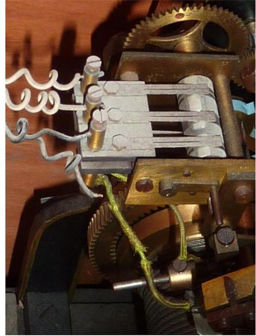
Der Quecksilberschalter ist mit dem langsam wendenden Polwender in Reihe geschaltet. Unten ist der Quecksilberschalter gerade durchgeschaltet und wird langsam wieder in seine Ruhelage gebracht.
