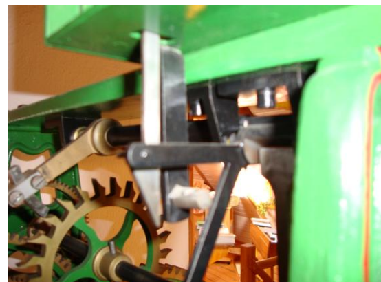
Der hakenförmige Auslösehebel, Foto: Schnabel
