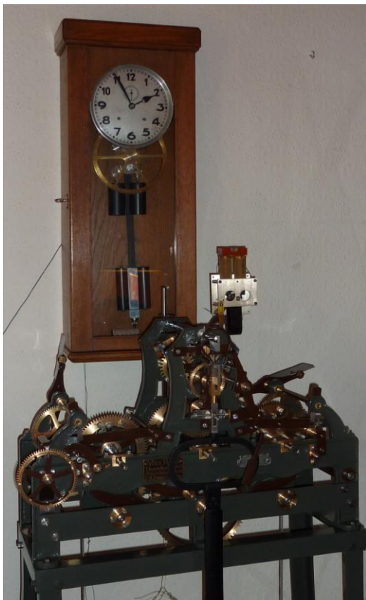
Turmuhren mit automatisch-elektrischem Aufzug für Drehstrom-, Wechselstrom- und Gleichstrom-Motoren
