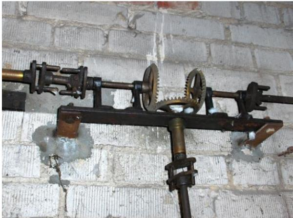
Die direkte Ankopplung auf die Achse des Minutenzeigers des nach Osten zeigenden Zifferblatts. Nach Untersetzung 1:12 wird das Stundenrohr, das die Minutenachse umgibt, angesteuert.
