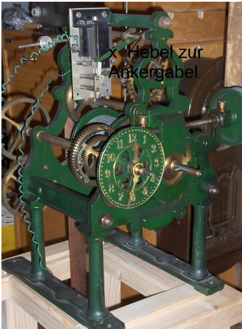
Abb. 1: Gehwerk von Mäder mit Synchronisation durch eine Normaluhr
