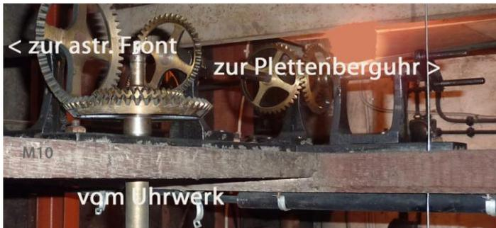
**Abb. 5, von unten links nach oben rechts: Kopplung der Nebenuhr an das Domuhrwerk ab 1933. Die Gabel ganz rechts geht heute ins Leere, stellte aber vor dem Krieg die mechanische Verbindung zur Plettenberguhr her. Foto: Mosel.**
