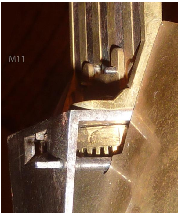
Abb. 5 . Aufwendige aber typische Einstellung der Längenkorrektur des Pendels. Foto Mosel.
