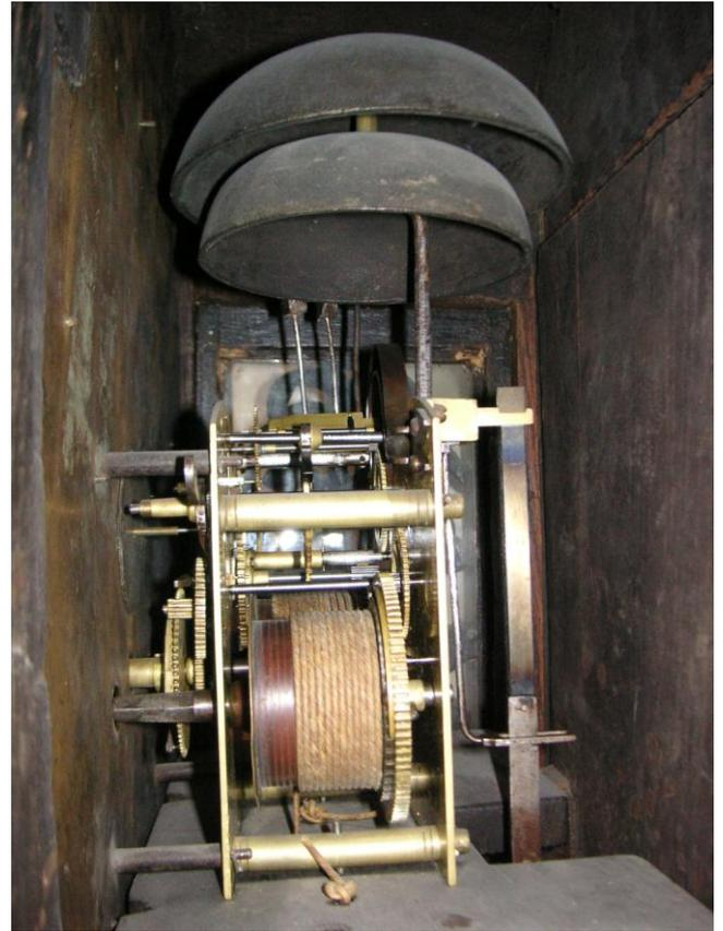
In Abb. 8 erkennt man an der Eisen-Messing-Querachse eine automatische Halb-Voll-Umschaltung des Glockenschlags, die sehr ungewöhnlich realisiert ist. Sie sollte so eingestellt sein, dass die volle Stunde gleichzeitig auf zwei Glocken und die halbe Stunde nur auf die kleinere Glocke geschlagen wird.
