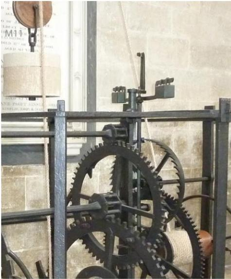
**Abb. 4 . Salisbury 1386, auf Waag 1956 zurückgebaut. Täglicher Fehler etwa  $\pm 15$  min. Foto: Mosel**
