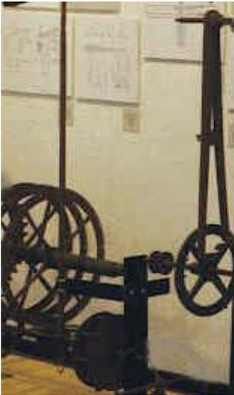
**Abb. 15 . Links: Getriebeteile der Planeten, rechts: die Stiftenhemmung von 1818.**
